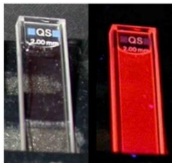
Image de microscopie électronique d'un nanocristal de YVO_4:Eu et photographies d'une suspension colloïdale en lumières blanche et UV montrant la luminescence rouge caractéristique de l'euprium Eu^{3+} .
