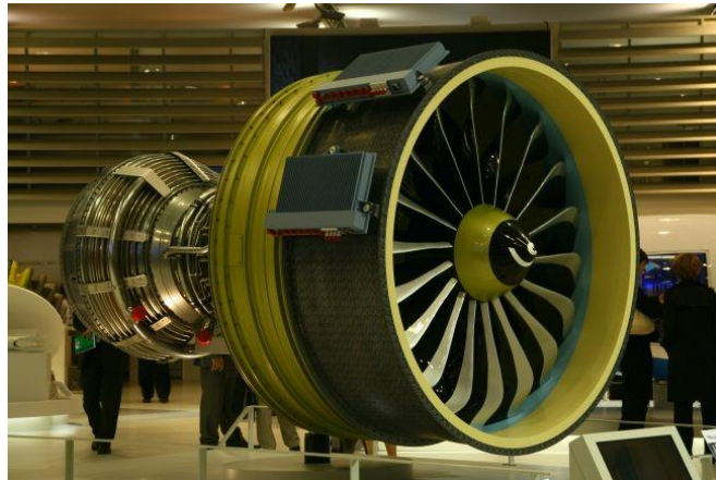
Moteur Leap de SNECMA (groupe Safran) : de nombreuses pièces sont réalisées en matériaux composites
